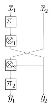
При подходящем выборе подстановок  $\pi_1$ ,  $\pi_2$ ,  $\widehat{\pi}_1$ ,  $\widehat{\pi}_2$  подстановка типа «А» задает 6-равномерную подстановку, имеющую нелинейность 108, алгебраическую степень 7, графовую алгебраическую иммунность равную 3
